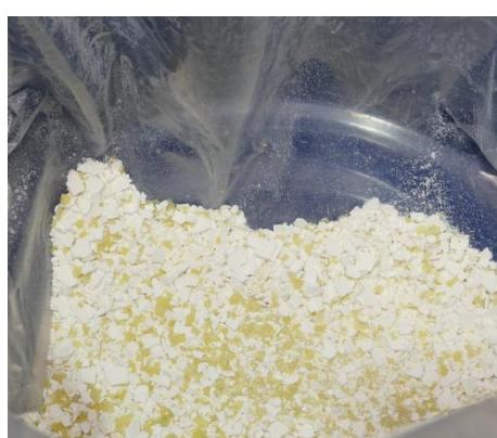
Ces gels érodent une très fine épaisseur de leur support. La contamination fixée est sapée puis migre dans le gel. Lors du séchage, il se fracture jusqu'à former des écailles sèches, elles se détachent en paillettes aspirables.
